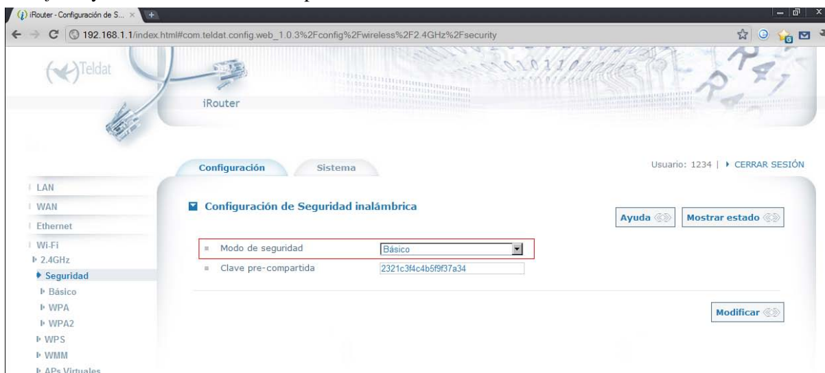
Figura 21. Modo de seguridad con encriptación WEP
