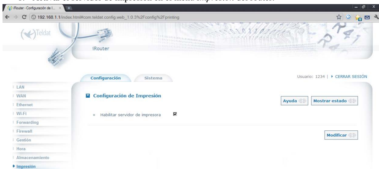
Figura 30. Servidor de impresión en el Home Station Fibra Óptica
