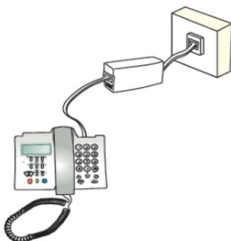
Figura 3.2 Cableado en el microfiltro simple
