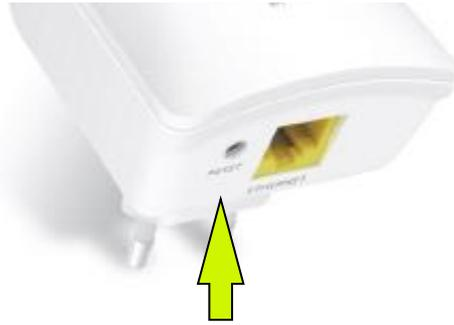
Para acceder a la Utilidad del Repetidor Inalámbrico 11n, abre un navegador web e introduce en la barra de direcciones la siguiente dirección IP: 192.168.1.130.
