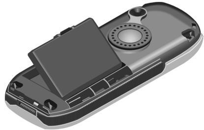
2. Coloque la tapa de la batería ligeramente inclinada e introduzca primero las dos pestañas inferiores en la carcasa. A continuación, coloque la tapa teniendo en cuenta la posición de la cámara hasta que encaje.
