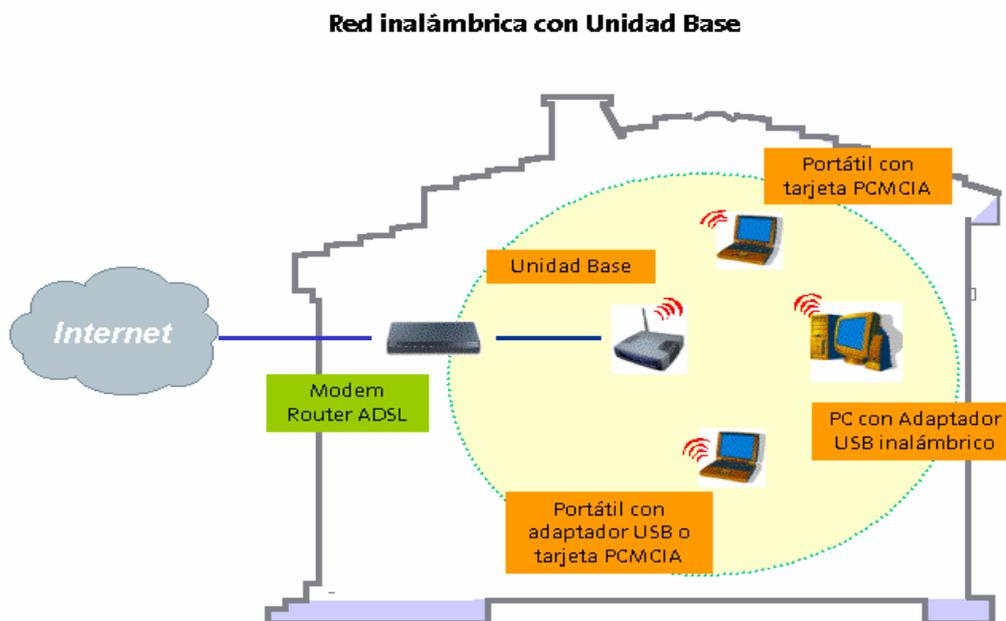
La unidad base actúa como "pasarela" convirtiendo la señal de datos Ethernet en señales radio 802.11b, proporcionando el enlace con los clientes inalámbricos. Estos clientes se pueden desplazar libremente por toda la zona de cobertura de la unidad base permaneciendo conectados a la red local. Así los clientes inalámbricos podrán tener acceso a Internet y a los recursos comunes de la red Ethernet cableada, así como compartir información con otros clientes cableados e inalámbricos de la red.
