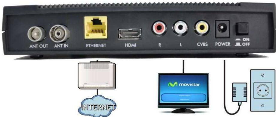
En el caso de que tu TV sea de alta definición (Full HD o HD Ready) puedes conectar el descodificador mediante el interfaz HDMI, tal como se muestra en la figura siguiente:
