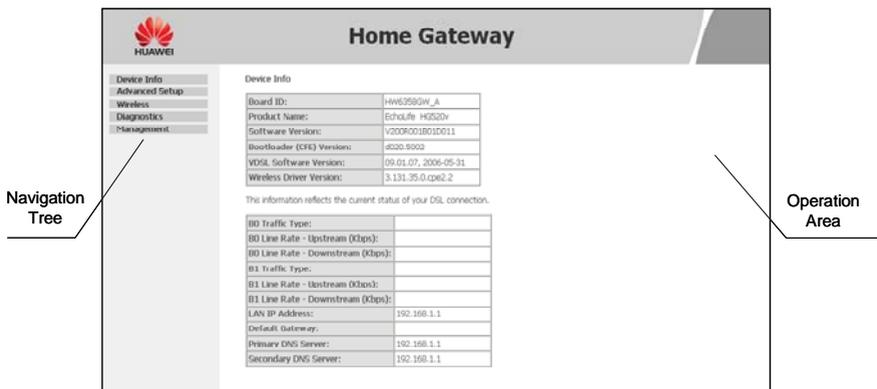
**Figure 2-1** Homepage del gestor de configuración Web
