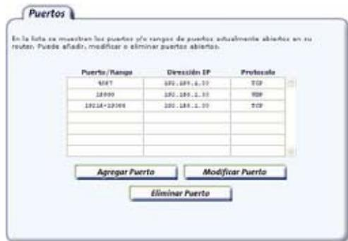
Figura 2.19 Ejemplo de lista de puertos abiertos en el router
