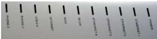
Figura VI.1 Panel frontal de indicadores luminosos del router FTTH
