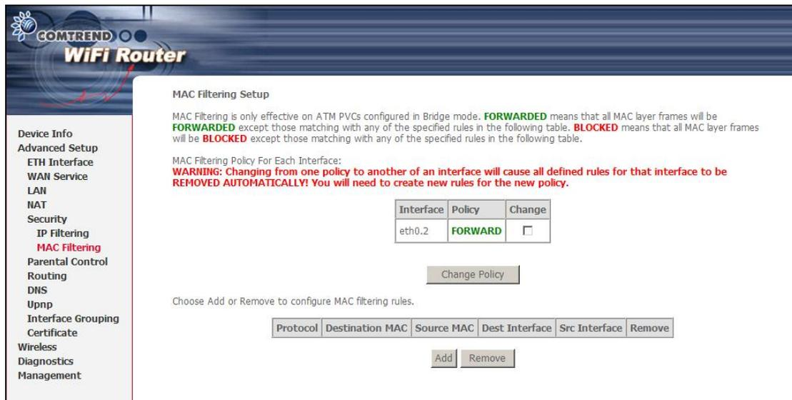
Haga clic en el botón **“Add”** o en el botón **“Remove”** para configurar las reglas de filtrado MAC. La siguiente imagen aparecerá al hacer clic en el botón **“Add”**. Crear un filtro para identificar frames en la capa MAC puede especificar al menos una condición. Si especifica más condiciones, todas ellas deben cumplirse. Haga clic en el botón **“Save/Apply”** para salvar y activar la regla de filtrado.
