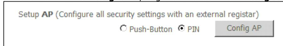
**Paso 7:** Active la funcionalidad PIN en el cliente inalámbrico. Para modo **"Configured"**, el cliente debe estar configurado como un **"Enrollee"**. Para modo **"Unconfigured"**, el cliente debe estar configurado como el **"Registrar"**. Este es diferente a la funcionalidad External Registrar incorporada en Windows Vista.
