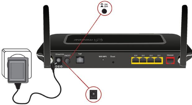
El panel posterior del “Router Fibra Óptica” presenta los conectores y el interruptor que se muestran en la siguiente figura:
