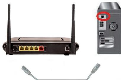
Figura 4.5 Conexión del "Router Fibra Óptica" a la tarjeta Ethernet
