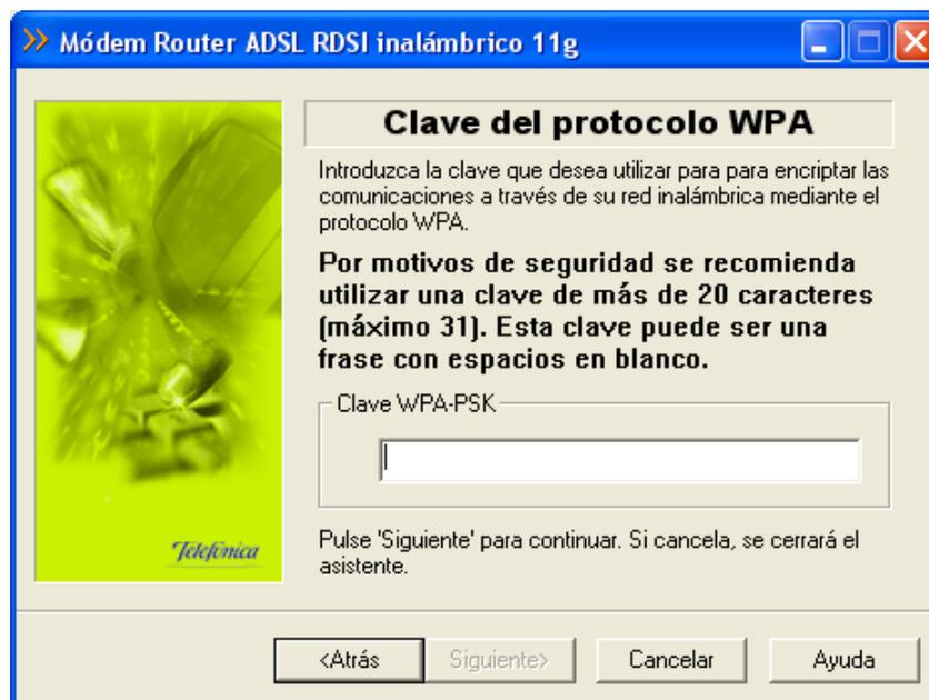
**Figura 4-5: Ejemplo de pantalla de Asistente de configuración para la introducción de una clave WPA-PSK**
