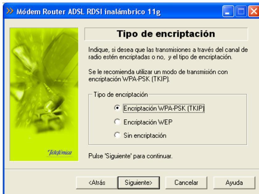
**Figura 4-4: Ejemplo de pantalla de *Asistente de configuración* para la elección del tipo de encriptación**
