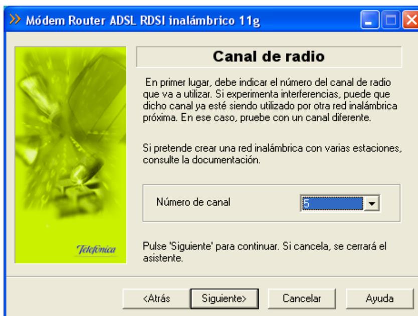
Figura 4-2: Ejemplo de pantalla de *Asistente de configuración* para la selección del canal de radio
