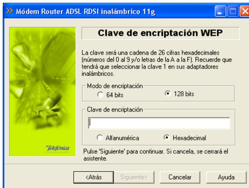
**Figura 4-6: Ejemplo de pantalla de Asistente de configuración para la introducción de una clave WEP**
