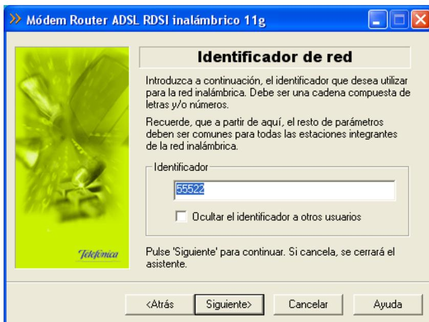
Figura 4-3: Ejemplo de pantalla de *Asistente de configuración* para la introducción de SSID
