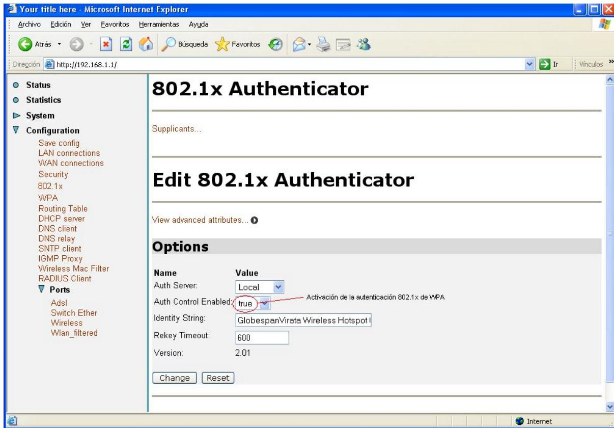
**Figura 3-31: Activación del control 802.1x**
