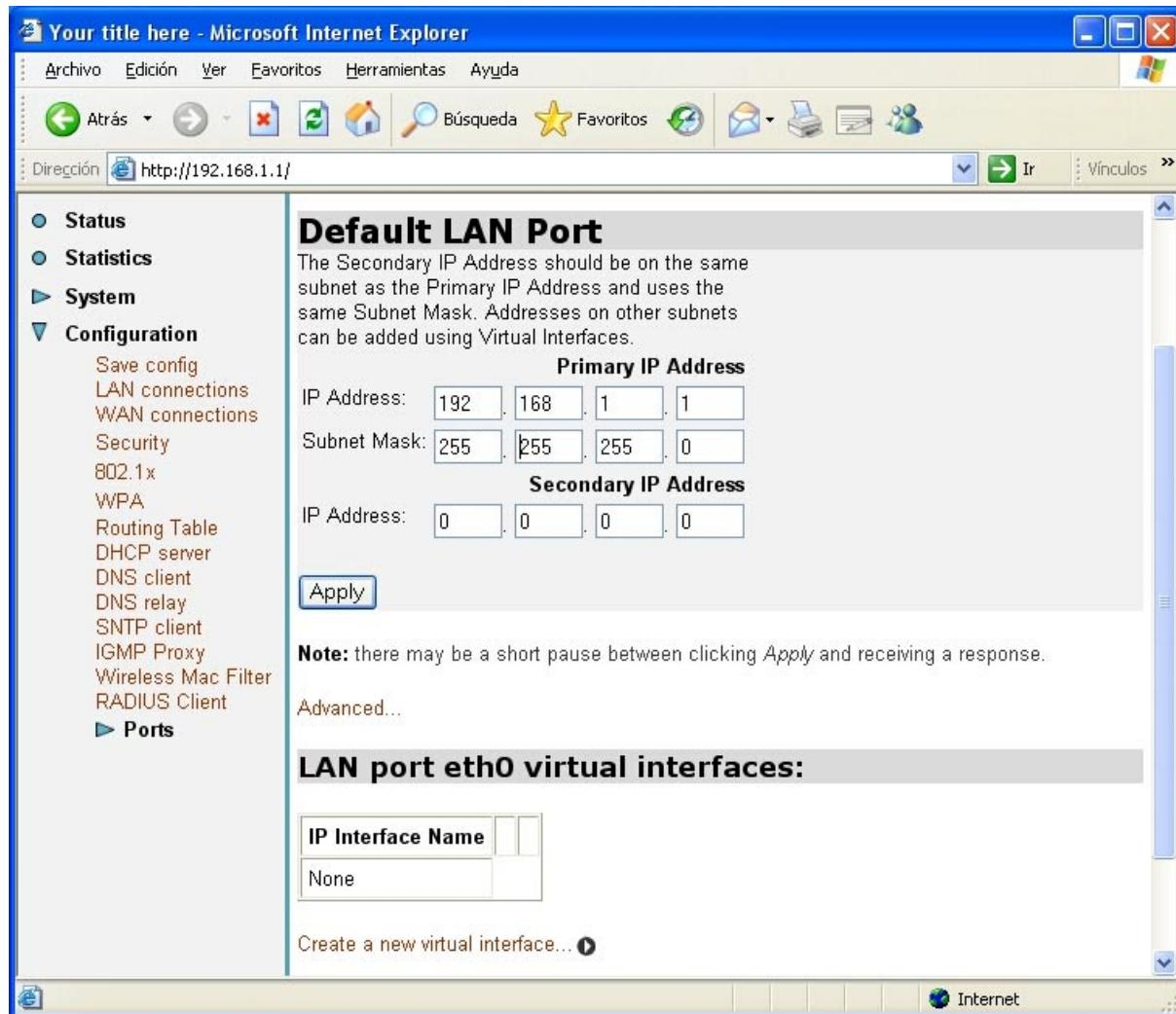
**Figura 3-11: Dirección IP del router**
