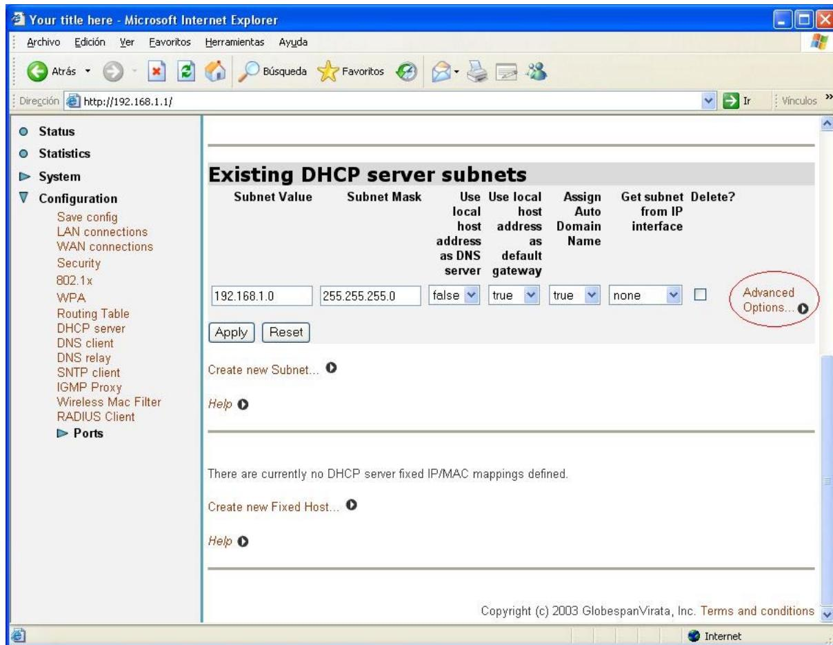
**Figura 3-8: Opciones de configuración del servidor DHCP (I)**
