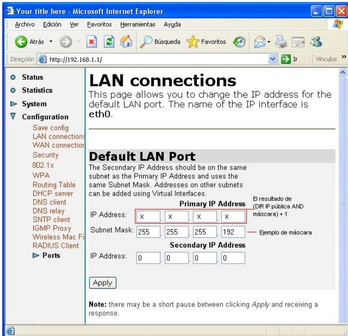
**Figura 3-20: Dirección IP del router en monopuesto estático**
