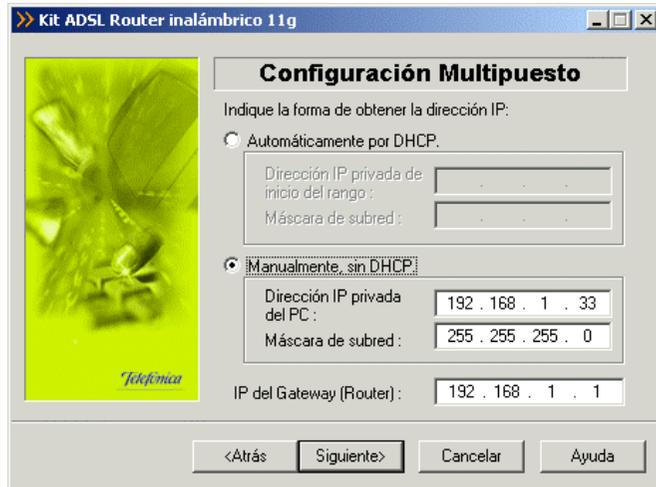
Figura 4.30 Datos de configuración para modo multipuesto (manual)
