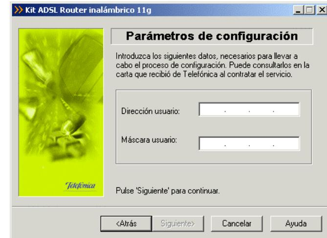
Figura 4.27 Datos de configuración para direccionamiento estático
