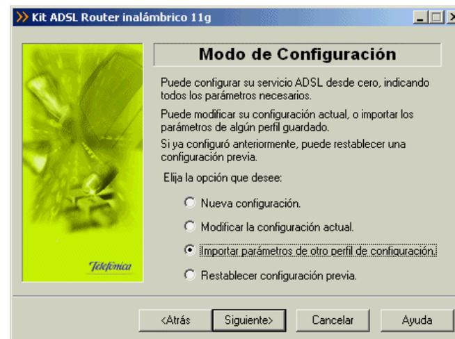
Figura 4.57 Selección del tipo de configuración a realizar: Importar parámetros de otro perfil de configuración
