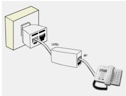
Figura 3.1 Cableado en el microfiltro
