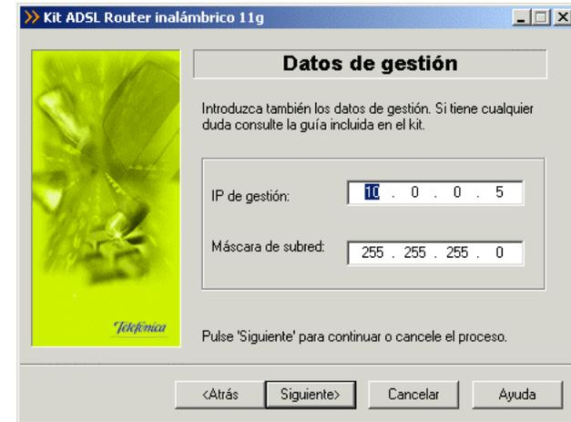
Figura 4.31 Datos de configuración para modo monopuesto con direccionamiento estático
