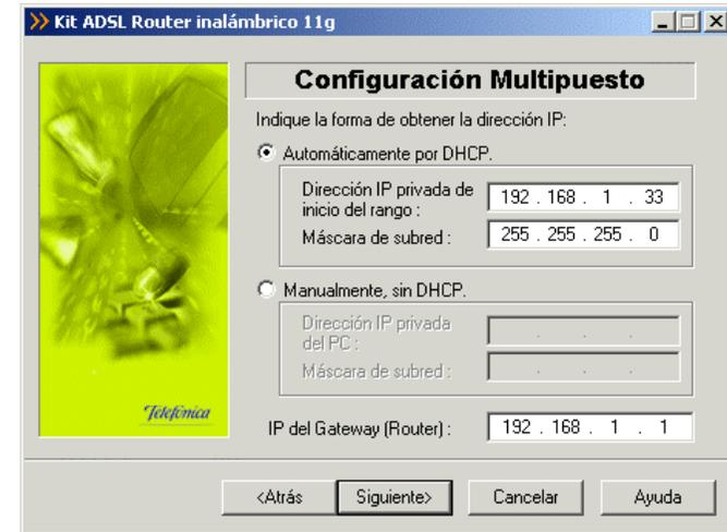
Figura 4.29 Datos de configuración para modo multipuesto (DHCP)
