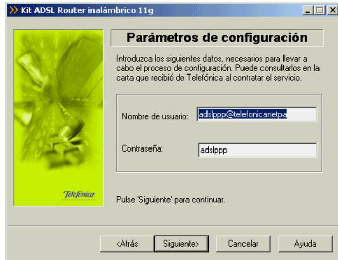
Figura 4.28 Datos de configuración para direccionamiento dinámico
