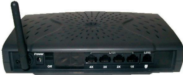
Figura 3.2 Vista posterior del router ADSL
