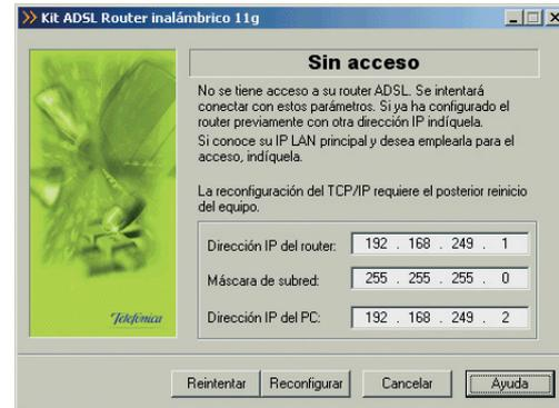
Figura V.4 Reconfigurar TCP/ IP
