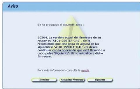
Figura IV.1 La versión de firmware no coincide con la homologada por Telefónica
