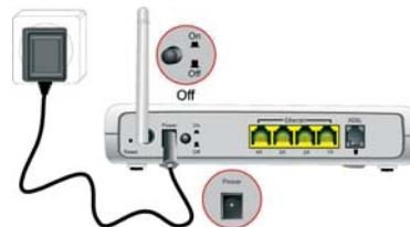
Figura 3.5 Conexión del router ADSL a la red eléctrica
