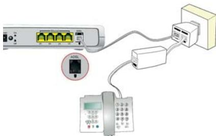
Figura 3.3 Conexión del router ADSL a la roseta
