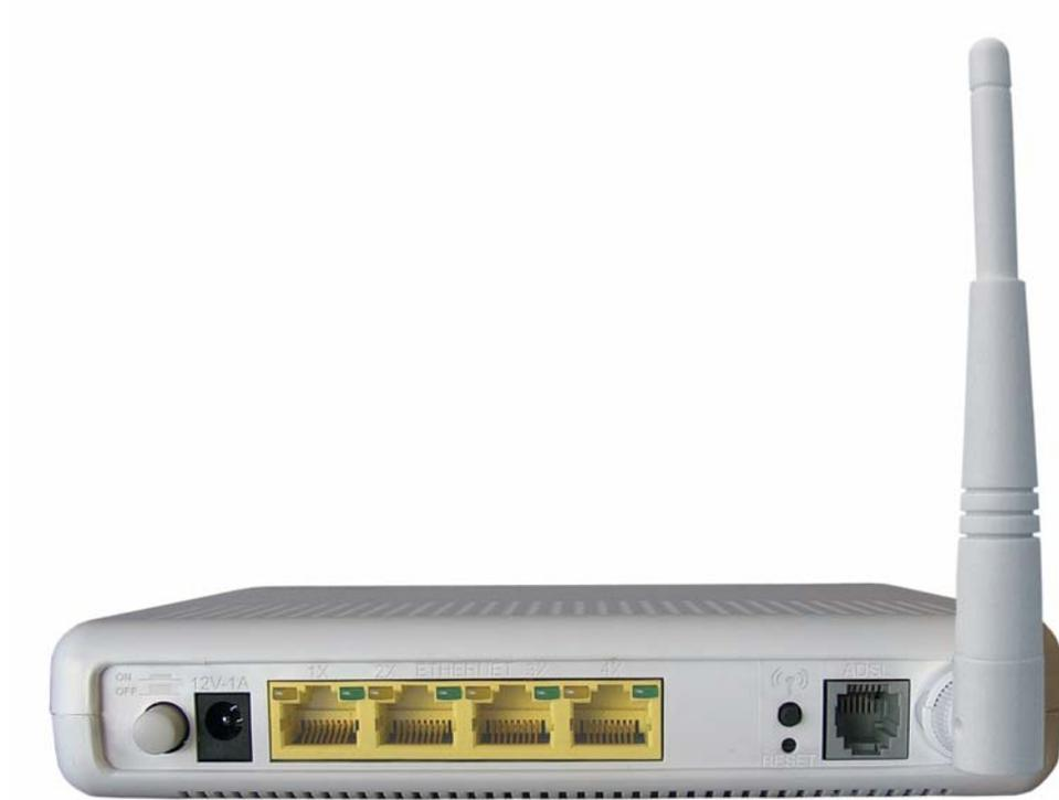
**Figura 3: Conexiones del panel posterior**
