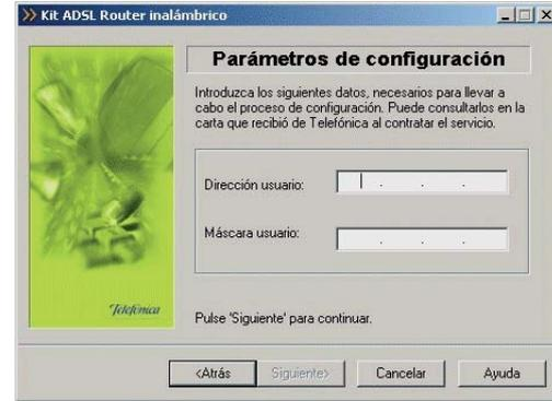
Figura 4.31 Datos de configuración para direccionamiento estático
