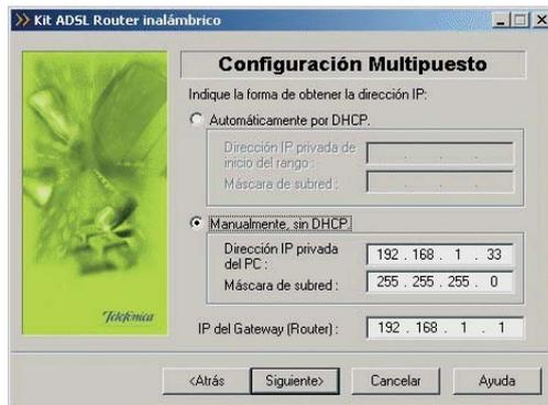
Figura 4.34 Datos de configuración para modo multipuesto (manual)
