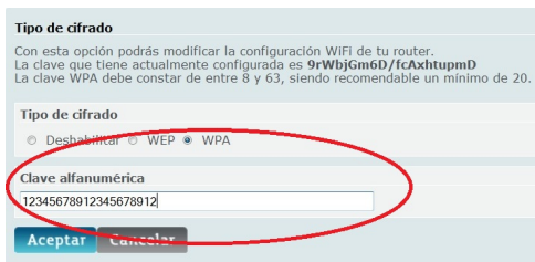
Figura 4-5: Ejemplo de pantalla para la introducción de una clave WPA-PSK
