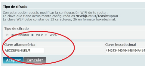
Figura 4-6: Ejemplo de pantalla para la introducción de una clave WEP
