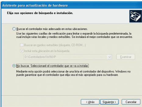
Figura 4.8 Seleccionar la opción para indicar manualmente el controlador a instalador
