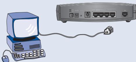
3. Conecte el cable de puerto serie a un conector libre de este tipo en el PC y al conector "CONSOLE" en el módem.
