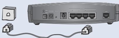
2. Conecte el cable de red Ethernet a la tarjeta Ethernet del PC por un extremo y por el otro a uno de los conectores LAN 1, 2, 3 ó 4 del módem.
