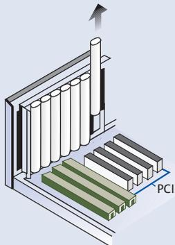
4. Inserte la tarjeta Ethernet, suministrada con el kit, en la ranura PCI libre, atornillándola para que quede fijada.
