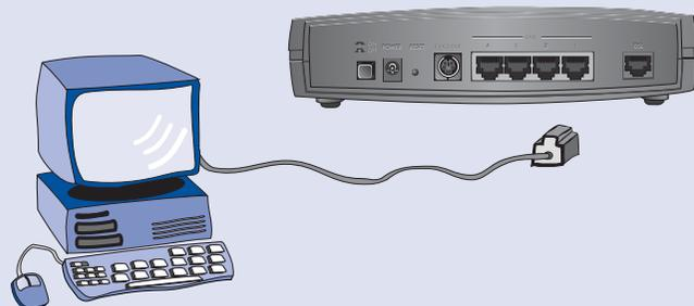
3. Conecte el cable de puerto serie a un conector libre de este tipo en el PC y al conector *Consola* en el módem.
