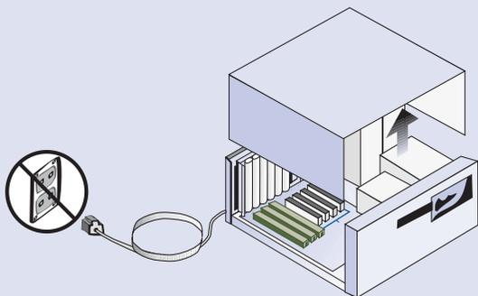
3. Identifique una ranura libre en formato PCI. Retire la placa protectora y reserve el tornillo para la fijación de la tarjeta.
