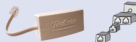
4. Conecte el terminal telefónico a la entrada del microfiltro.
