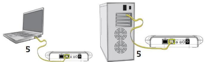
Figura 3.5 Conexión del Router ADSL a la tarjeta Ethernet
