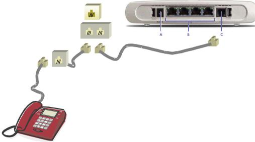
**2.-** Conecte el cable de red Ethernet gris a la tarjeta Ethernet del PC, por un extremo, y por el otro extremo a uno de los cuatro conectores LAN del módem router ADSL. Cualquiera de ellos puede ser utilizado.
