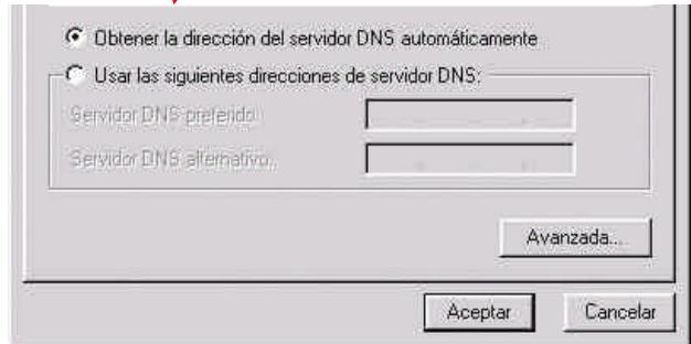
En 'Configuración DNS' seleccionar la opción 'Obtener la dirección del servidor DNS automáticamente'. (8) Pulse 'Aceptar'.
