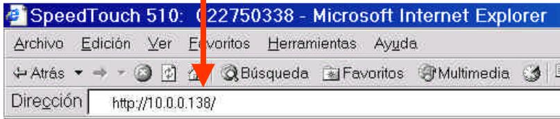
Dicha dirección IP es una dirección IP privada para acceso a la gestión del módem router ADSL. Se le solicitará la contraseña creada en el proceso de configuración original, rellene el campo correspondiente.
