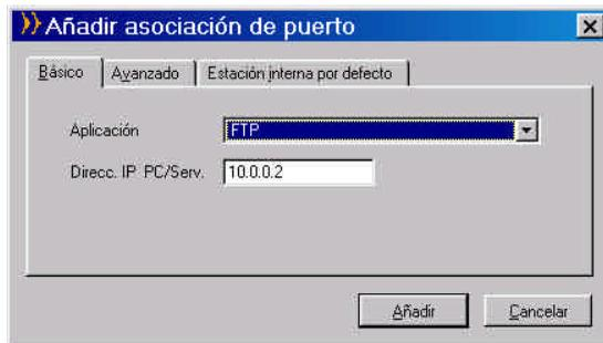
En la opción "Básico", bastará con explicitar la dirección IP del PC o Servidor a la que se desea asociar una determinada aplicación del menú de "Aplicación" contiguo. Por defecto el configurador propone la dirección IP del PC desde la que realizamos la Gestión de puertos. En dicho menú de "Aplicación" se muestra una lista de las aplicaciones más comunes.
