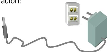
Cable ADSL negro (Cable telefónico RJ-11, terminado en dos conectores macho pequeños para conectar su módem router ADSL a la clavija extensora):
