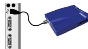
6. Continúe con la configuración. Una vez que haya finalizado, el indicador *Datos* deberá parpadear para identificar la transmisión de datos. En caso contrario compruebe la conexión del cable USB de su módem con el PC.
