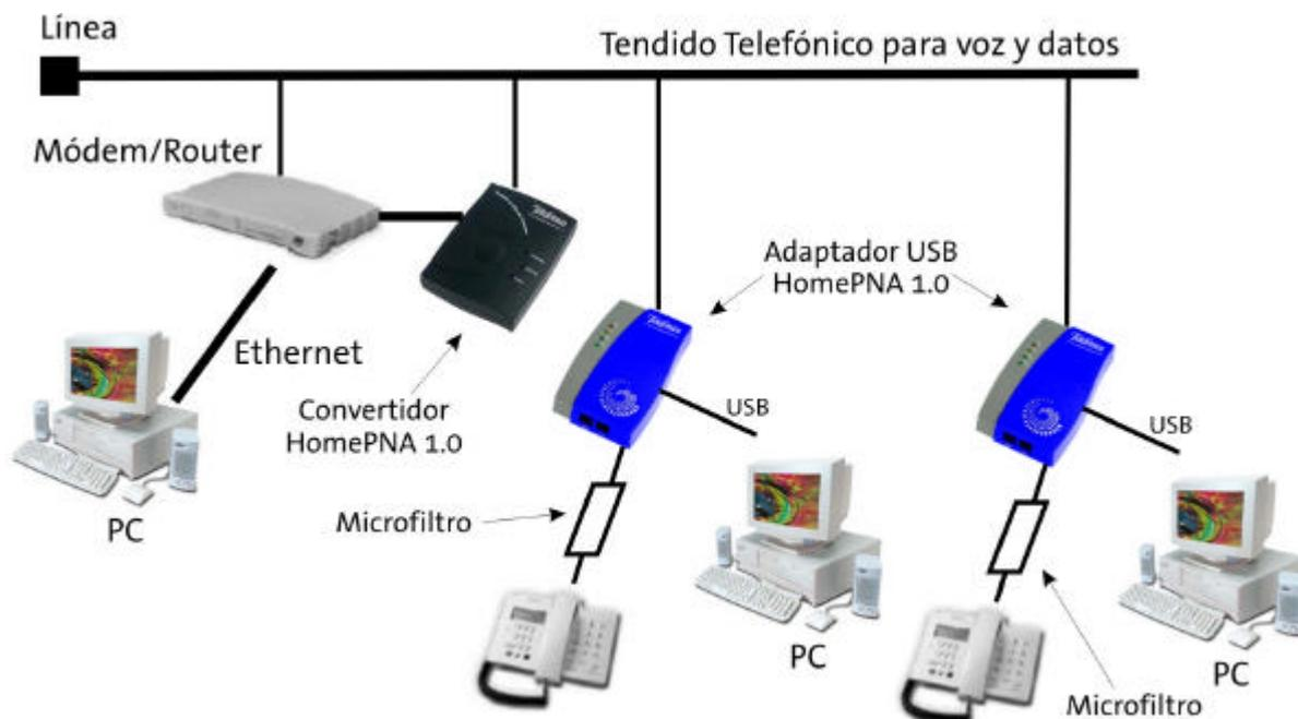
Como puede comprobar, en este caso, se utiliza una única tirada de cable. La señal que sale del Módem/Router en formato Ethernet se convierte a un formato HomePNA 1.0 que puede ser transmitido por el cable de dos o cuatro hilos que se utiliza también para la voz. En los puntos donde hay teléfonos se pueden instalar Adaptadores USB HomePNA para instalar PCs y que se puedan conectar entre ellos y acceder a Internet mediante el Módem/Router.
