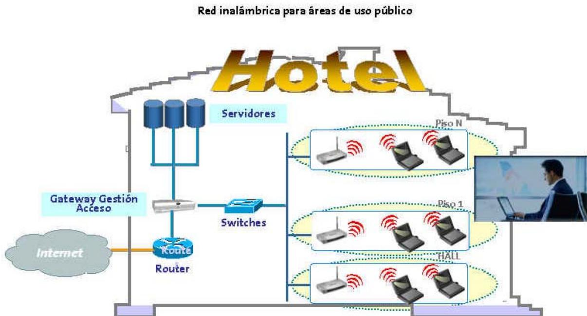
En este caso los puntos de acceso inalámbrico son propiedad del proveedor del servicio. En resumen, para utilizar este tipo de red local inalámbrica, debe usted disponer del siguiente equipamiento:
