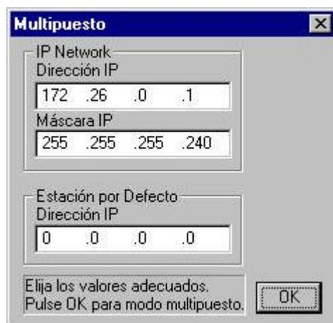
Esta pantalla le ofrece la posibilidad de instalar el Módem/Router en una dirección IP por defecto. Esta dirección es 172.26.0.1 / 255.255.255.240.
