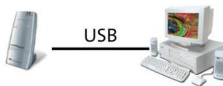
La Red L@R ADSL no puede ser instalada con Módems USB. Es necesario que el dispositivo de conexión sea un Módem/Router con puerto Ethernet.
