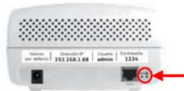
Al completar el reset por defecto, los dos indicadores luminosos de la derecha se quedan parpadeando.
