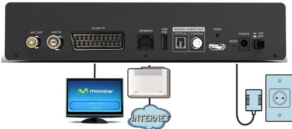
En el caso de que tu TV sea de alta definición (Full HD o HD Ready) puedes conectar el descodificador mediante el interfaz HDMI, tal como se muestra en la figura siguiente:
