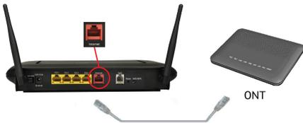
En el momento que enciendas el Router Fibr Óptica (ver siguiente apartado) puedes verificar que la conexi3n con la ONT se ha establecido correctamente porque el indicador "Lnea" se encenderá de color verde:
