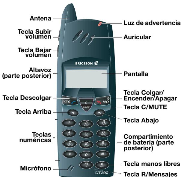
La siguiente lista explica la utilización de los botones y teclas del teléfono inalámbrico.
