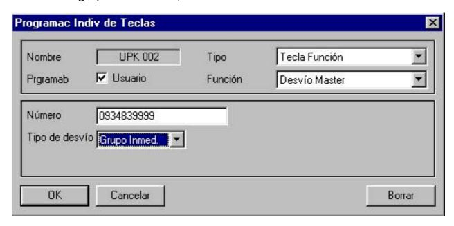
**Nota:** Para poder activar cualquier desvío con destino externo, mediante la tecla desvío master o activación directa, hay que tener autorizado en la extensión el servicio de desvío externo.
