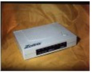
Se usa para operaciones de acceso remoto al sistema. Se conecta al puerto COM1 de la tarjeta de comunicaciones digitales
