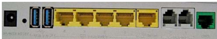
Figura VI.2 Conectores traseros del router
