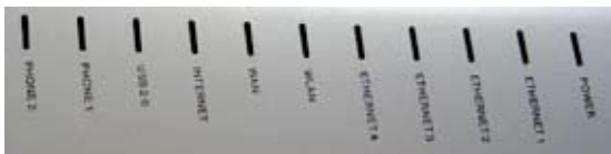
Figura VI.1 Panel frontal de indicadores luminosos del router FTTH
